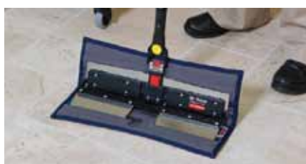
2. Deslice el armazón hacia los bolsillos
